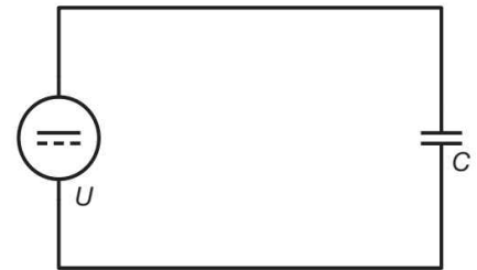
figuur 16.22 Een condensator is aangesloten op een gelijkspanningsbron.
