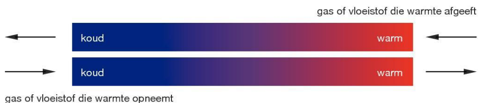
15.33 Schematische weergave van een warmtewisselaar
