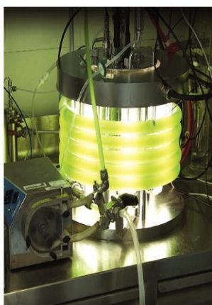
18.20 Waterstofproductie in een bioreactor door algen
