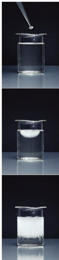
17.2 Snelle kristallisatie van natriumacetaat door toevoeging van een entkristal aan een oververzadigde oplossing
