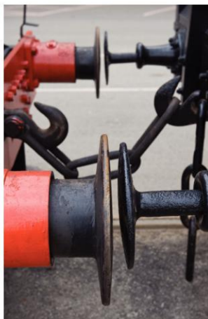
17.10 Bij de koppeling van treinstellen worden ook buffers gebruikt om de klap op te vangen.
