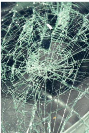
14.42 Een gebroken autoruit wordt bij elkaar gehouden door de polymeer in het composiet.
