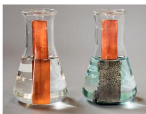
11.3 Een koperen plaatje in demineraal water links en een zilvernitraatoplossing rechts. Er ontstaat rechts een zilveren laagje op het koper.
