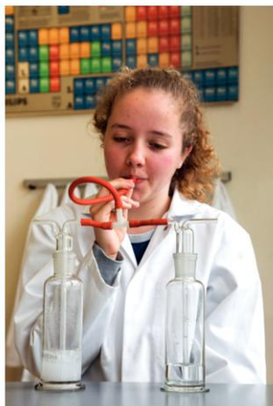
9.31 Beide wasflessen bevatten kalkwater. Er ontstaat een troebeling in de fles waar de uitgeademde lucht door gaat.
