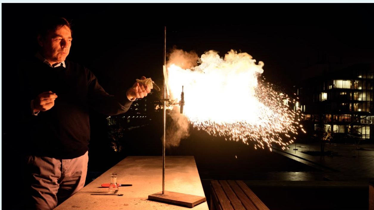
11.34 Demonstratie van de verbranding van 1 gram metaalpoeder in de lucht.
