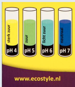
8.38 Een bodemtest om zelf de pH van je grond te testen
