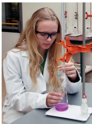
9.34 Een leerling voert een titratie met een buret uit.
