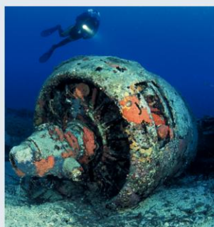
11.42 In zeewater roest ijzer heel snel zoals hier de met roest bedekte motor van een vliegtuigwrak in zee.
