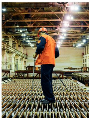
15.2 Grote aantallen elektrolysevatens naast elkaar. Het magnesiumchloride uit het krollproces kun je terugwinnen met elektrolyse.
