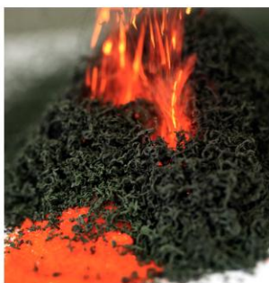
15.7 Het ontleden van ammoniumdichromaat levert een spectaculair proefje op. In verband met de giftigheid moet je dit in de zuurkast uitvoeren.
