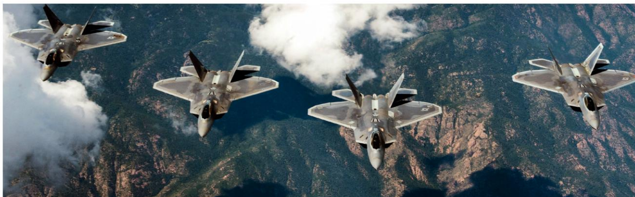
13.27 De kracht van polycarbonaat komt erg goed van pas bij de cockpit van de Lockheed Martin F-22 Raptor.
