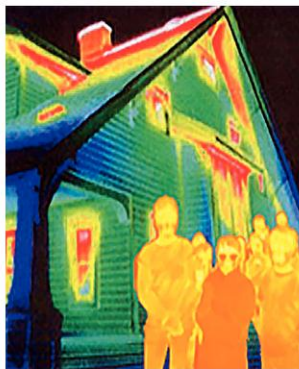
10.10 Met een warmtecamera kun je zien welke delen van je huis je moet isoleren.
