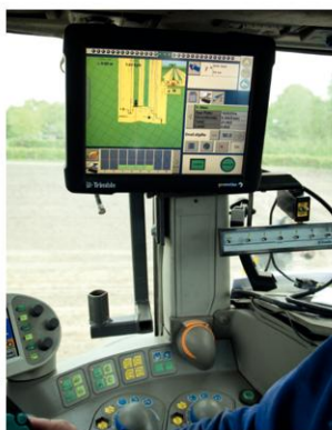
8.25 Het is door het gebruik van gps en sensoren mogelijk om bemesting van het land volledig geautomatiseerd te variëren en te doseren.
