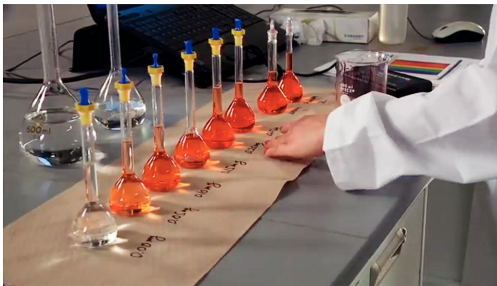
10.24 Spectrofotometrische bepaling van een ijkreeks met een oplopende concentratie ijzerthiocyanaationen
