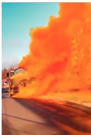
9.29 Een truck vervoerde geconcentreerd salpeterzuur toen een van de tanks openscheurde en een dikke oranje, corrosieve en zeer gevaarlijke wolk werd geproduceerd.
