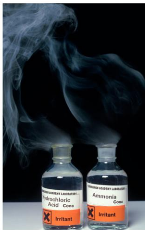
9.28 Als de damp van zoutzuur in contact komt met ammoniakgas, zie je rook van salmiak ontstaan.
