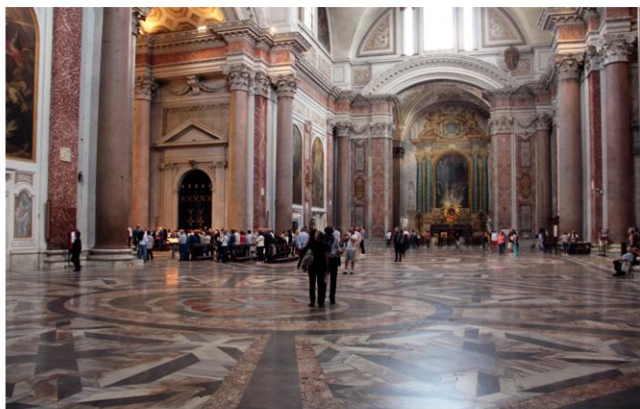
9.33 Marmer ( \text{CaCO}_3 ) zoals hier in de kerk van Santa Maria degli Angeli in Rome, mag je niet schoonmaken met zuur, het oppervlak wordt dan ruw.
