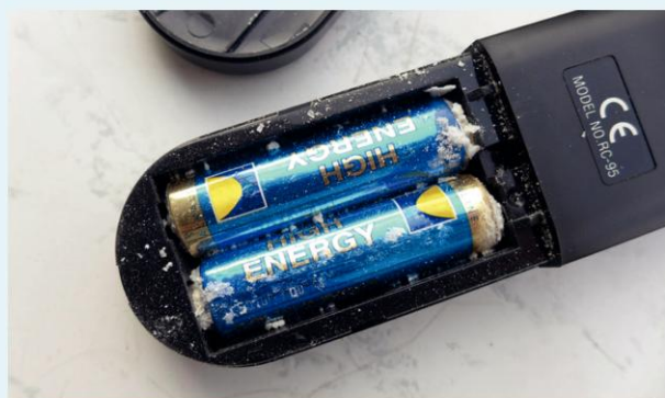
9.32 Een lekkende batterij laat een witte aanslag zien.
