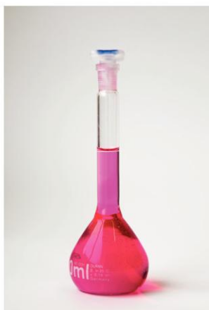
9.37 Maatkolf. Je zorgt ervoor bij het maken van de oplossing dat de onderkant van je vloeistofspiegel (de meniscus) precies op de maatstreep van de kolf staat.
