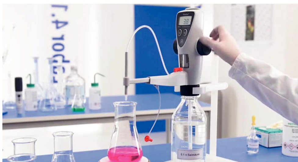
9.36 In grote laboratoria worden titraties niet handmatig uitgevoerd zoals in de klas, maar beschikt men over titratieautomaten zoals hier op de foto.
