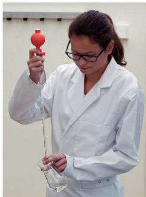
9.35 Gebruik van een pipet. Je kunt hiermee zeer nauwkeurig een bepaalde hoeveelheid van de te titreren oplossing nemen.
