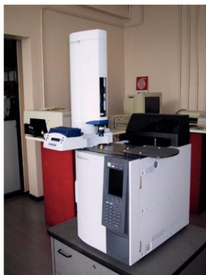
10.41 Een professionele gaschromatografie-opstelling in een laboratorium
