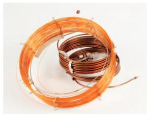
10.37 Verschillende typen kolommen die je kunt gebruiken bij gaschromatografie
