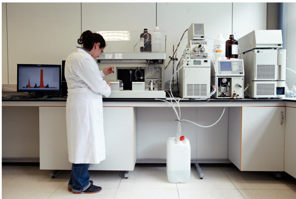
10.53 Een vloeistofchromatograaf gekoppeld aan een massaspectrometer: LC-MS
