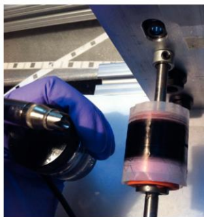
14.49 Bespuiten van nanobuisjes op een draaiende spoel met een polymeer
