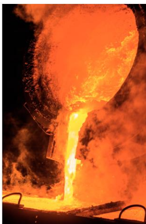
11.17 Gloeiend vloeibaar ijzer wordt vanuit een hoogoven in een kuip gegoten. De productie van ijzer is een van de bekendste processen waarbij redoxreacties verlopen.
