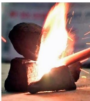
11.13a Van het redoxkoppel F_2/F^- is fluorgas een sterke oxidator. Het reageert zeer heftig met metalen zoals hier met cesium.
