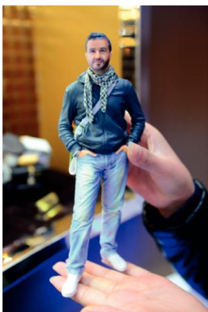
13.14 In Nanjing in China kun je een lichaamsscan laten maken en daarna jezelf 3D laten printen in de gewenste grootte. Polymelkzuur is zeer geschikt als 3D-printmateriaal.
