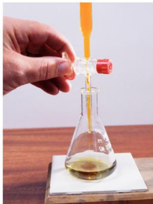
11.23 Titratie van een kleurloze oplossing van oxaalzuur met een aangezuurde geel/oranje oplossing van kaliumdichromaat. Er ontstaat een groene oplossing door \text{Cr}^{3+} -ionen.
