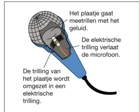
8.6 Een microfoon zet geluid om in een elektrische trilling.
