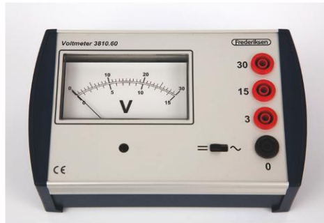
6.5a Een voltmeter. De keuze van de rode aansluiting bepaalt het meetbereik.
