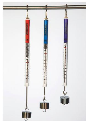
7.5 Veurunsters met verschillend meetbereik met een doorzichtige buis.
