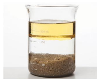
3.17 Dit mengsel van olie, water en zand is door middel van bezinken gescheiden.
