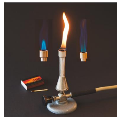
1.5 De gasregelknop van de brander bepaalt de grootte van de vlam. Met de luchtregelschijf verander je de kleur en temperatuur van de vlam. midden: schijf dicht, pauzevlam links: schijf open, vlam om te verwarmen rechts: gas vol open, ruisende vlam
