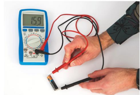
6.5b Een digitale voltmeter. De stand van de draaischijf bepaalt het meetbereik.
